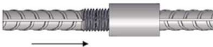
Рисунок В.3 – Сборка позиционного соединения без контргайки
