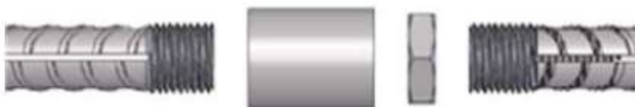
Рисунок В.5 – Сборка позиционного соединения с контргайкой
