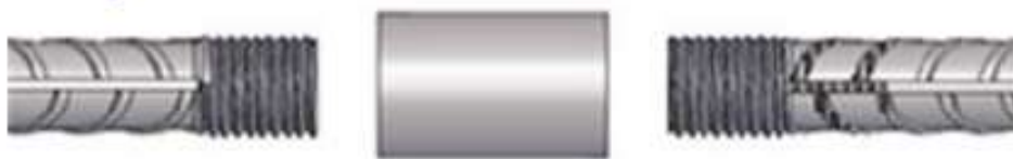
Рисунок В.1 – Сборка позиционного соединения без контргайки
