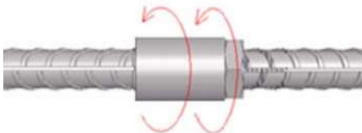
Рисунок В.8 - Сборка позиционного соединения с контргайкой
