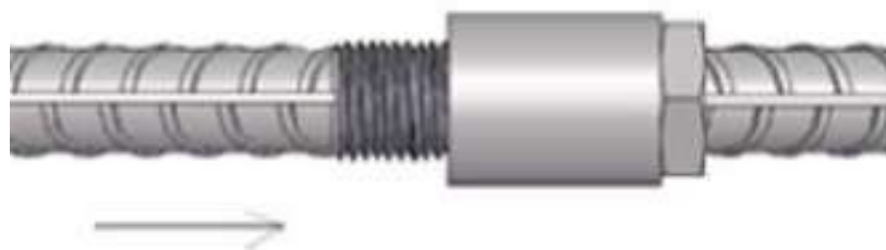
Рисунок В.7 - Сборка позиционного соединения с контргайкой
